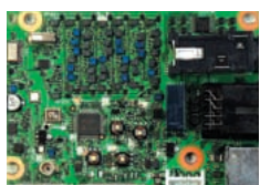
アイコム独自開発のDDS回路
