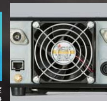
背面に装備されたクーリングファン
