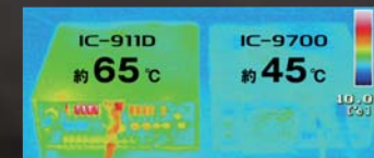
上記写真は15分間連続送信した際の背面シャーシ温度の比較です。IC-911Dが65°Cまで発熱しているのに対し、IC-9700は45°Cまでしか温度が上昇していません。
