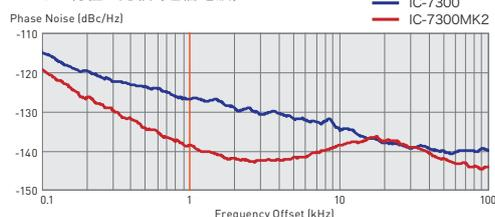
\* 2kHz離調(周波数: 14.2MHz、MODE: CW、IF BW: 500Hz)
